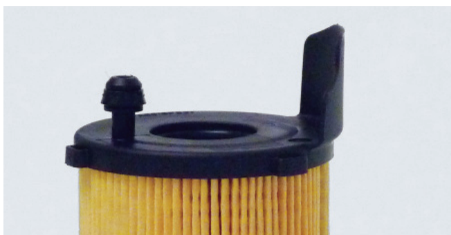
Рисунок 3: Имитация оригинального фильтра не нарушает патент MAHLE, но может вывести из строя перепускной клапан двигателя.
