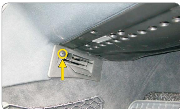
**PL** Filtr znajduje się pod schowkiem. Odkręcić wkręt końcówki kolektora wylotowego wentylacji
