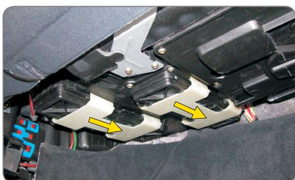
**PL** Przesunąć blokady zabezpieczające pokrywy komory filtra
