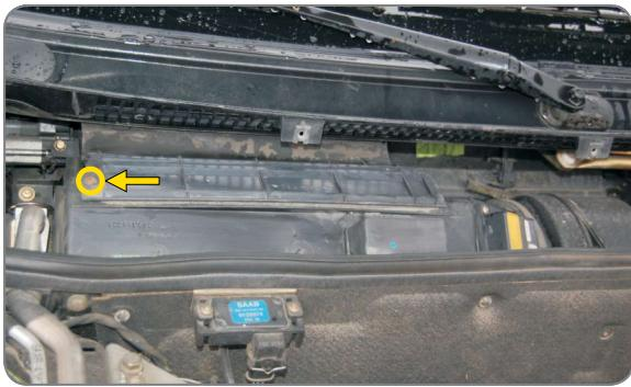
**PL** Odkręcić wkręt mocujący osłony filtra, wyciągnąć osłonę filtra
