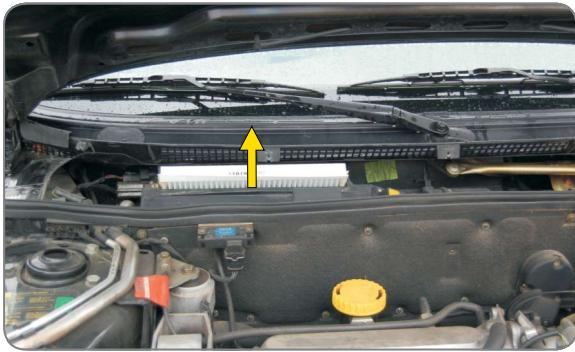
**PL** Ostrożnie usunąć zabrudzony filtr, następnie zamontować nowy oraz wykonać powyższe czynności w kolejności odwrotnej
