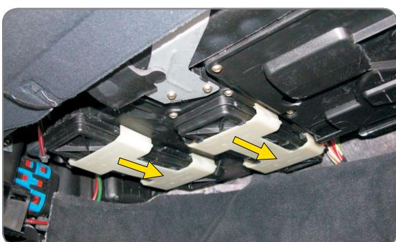
**PL** Przesunąć blokady zabezpieczające pokrywy komory filtra
