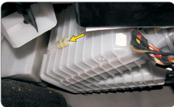
**PL** Odpiąć klipsy zabezpieczające obudowy filtra
