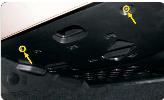
**PL** Odkręcić wkręty pokrywy filtra, usunąć pokrywę
