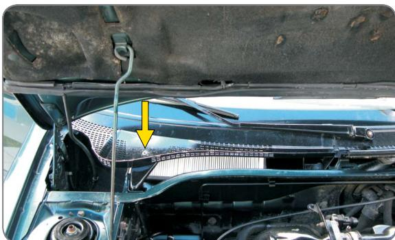
**PL** Odkręcić wkręty mocujące osłony pokrywy komory filtra
